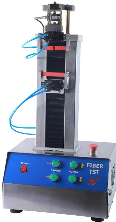
Es un medidor de esfuerzo a la tracción de fibras denominado Fiber TST (Tensile Strength Tester). Utiliza la más moderna tecnología de muestreo de datos en tiempo real, los cuales son almacenados y graficados.
